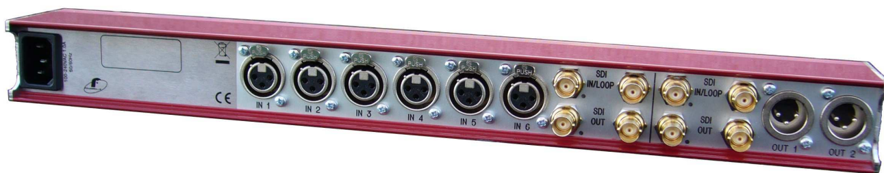
Face arrière convertisseur CS6AS2A-MI.
